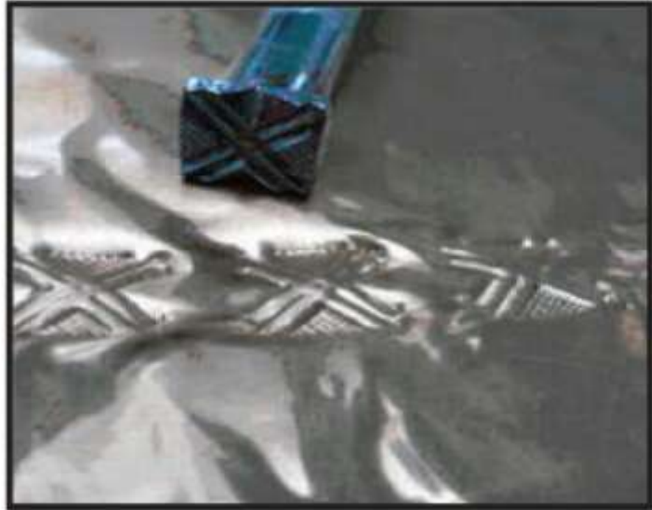
الشكل (١٠٨): أشكال تحدد نهاية الأزاميل التي يمكن عمل تشكيلات زخرفية.
