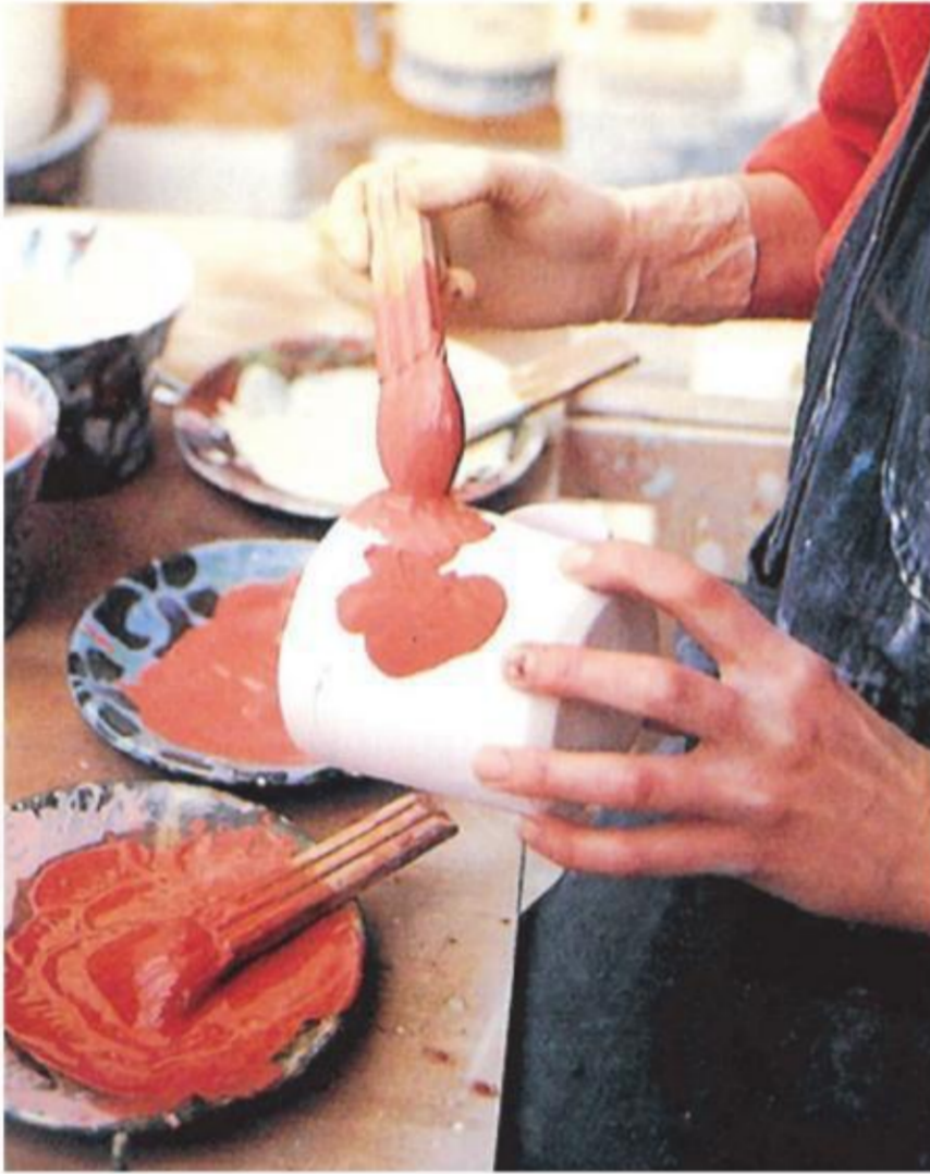
الشكل ( ٣٢ ) : استخدام الفرش ذات المقاسات الكبيرة لتطبيق البطانة على كامل القطعة .
